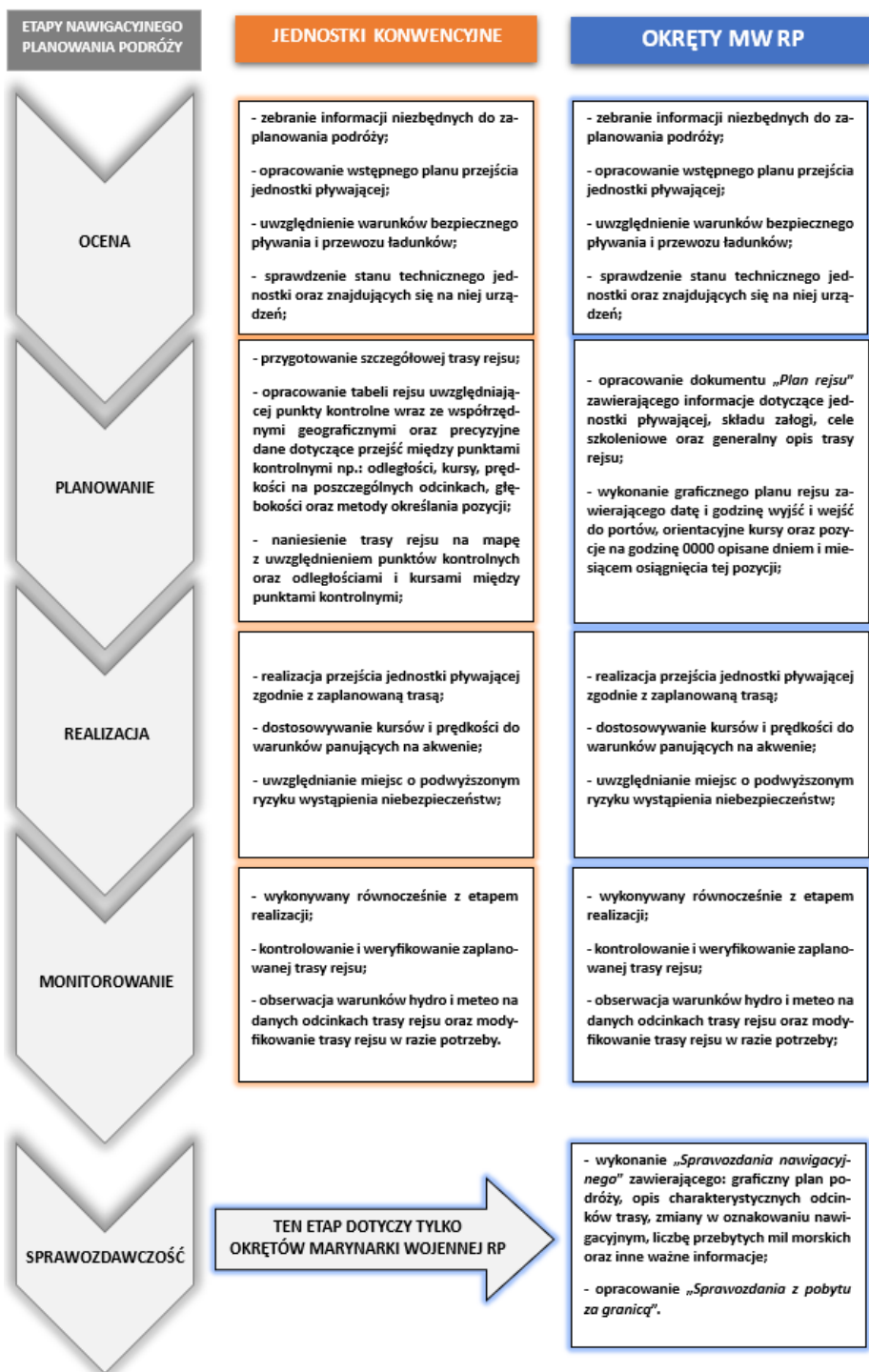
Rysunek 4. Porównanie procesu nawigacyjnego planowania podróży jednostek konwencyjnych i okrętów Marynarki Wojennej RP w formie schematu
